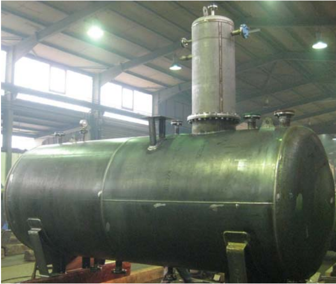
Entgasungsanlage in der Fertigungsphase
