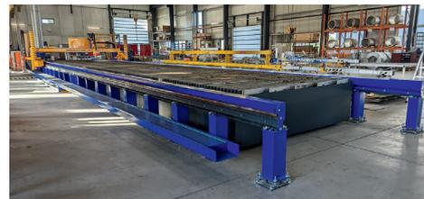
Die mit einer relativ hohen Abluftleistung von bis zu 9.600 m<sup>3</sup>/h arbeitende sequenzielle Absaugung im Schneidisch vermeidet Luftbelastungen in der Halle und gewährleistet damit einen hohen Arbeitsschutz. Die große Abluftleistung erfordert eine entsprechend große Zuluftmenge. Zur energetischen Optimierung wird deshalb die Wärme der Abluft in der Absauganlage direkt zum Vorwärmen der Zuluft verwendet. **Der thermische Wirkungsgrad dieser Absauganlage liegt bei annähernd 100%.**
