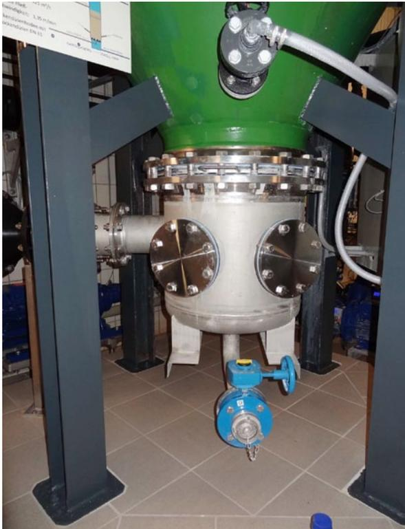
**Bild 2.** Neue Einströmung SEK-Reaktor.
