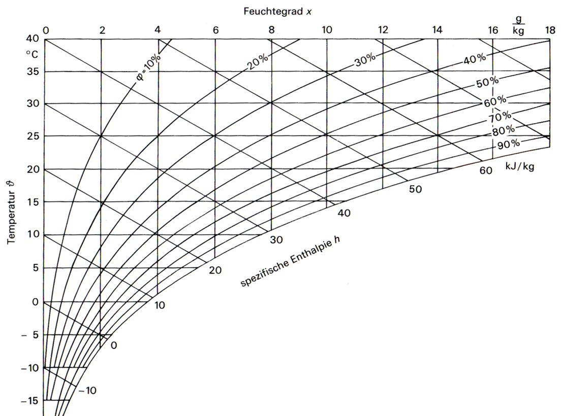
Der Zusammenhang zwischen der Temperatur, der Feuchte und der spezifischen Enthalpie der feuchten Luft ist im sogenannten Mollier-h-x-Diagramm zusammengefasst.
